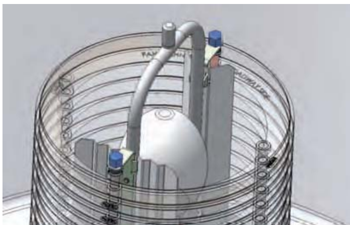
MTR Optik mit Multiprismenring und Spiegeloptik
